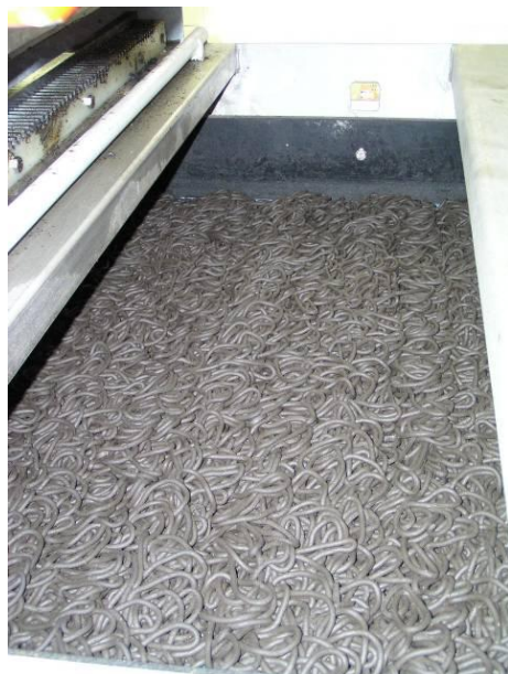
Fot.2. Zdjęcie przedstawia osad rozłożony przy pomocy dystrybutora na górnej taśmie suszarni.
