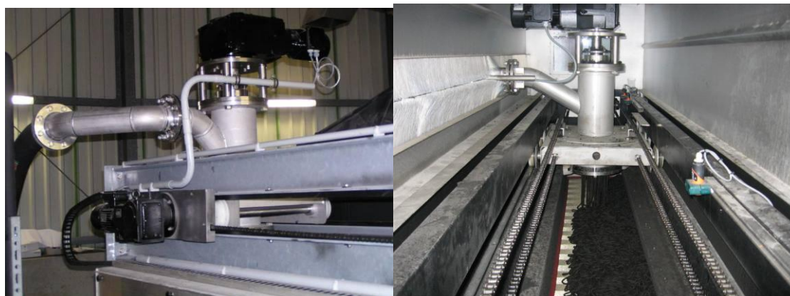
Fot.1. Zdjęcie przedstawia dystrybutor rozkładający osad na górnej taśmie suszarni.
